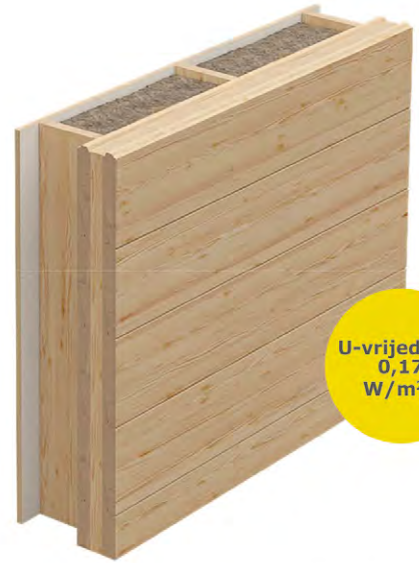
Panel + vanjska izolacija 240 mm + Honka fusion zid debljine 134 mm iznutra
