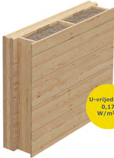
Honka Fusion zid 134 mm izvana + unutarnja izolacija 195 mm + panel
